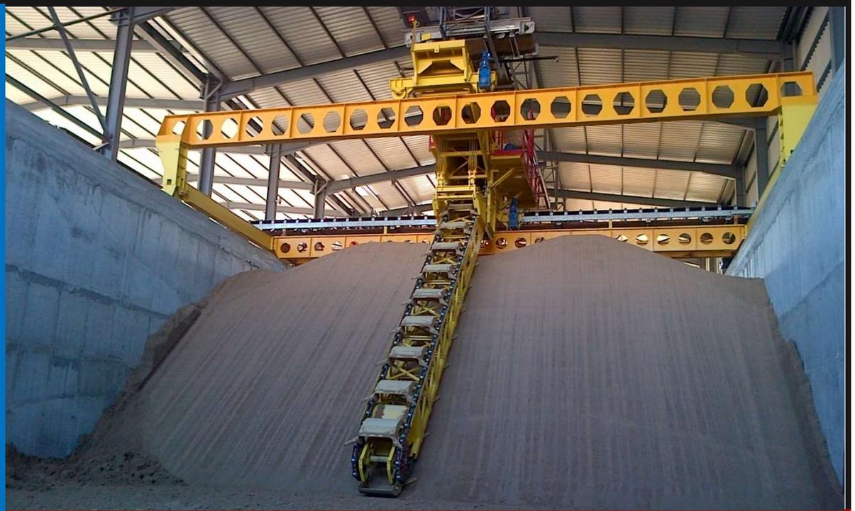
**L'EXCAVATEUR À GODETS SUR PONT EST UTILISÉ POUR LE STOCKAGE ET LE POURRISSAGE DES ARGILES PRÉALABLEMENT BROYÉES ET MALAXÉES.**
